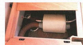
Fast an der Heckwand befindet sich die Truma Therme mit den Anlassventilen
